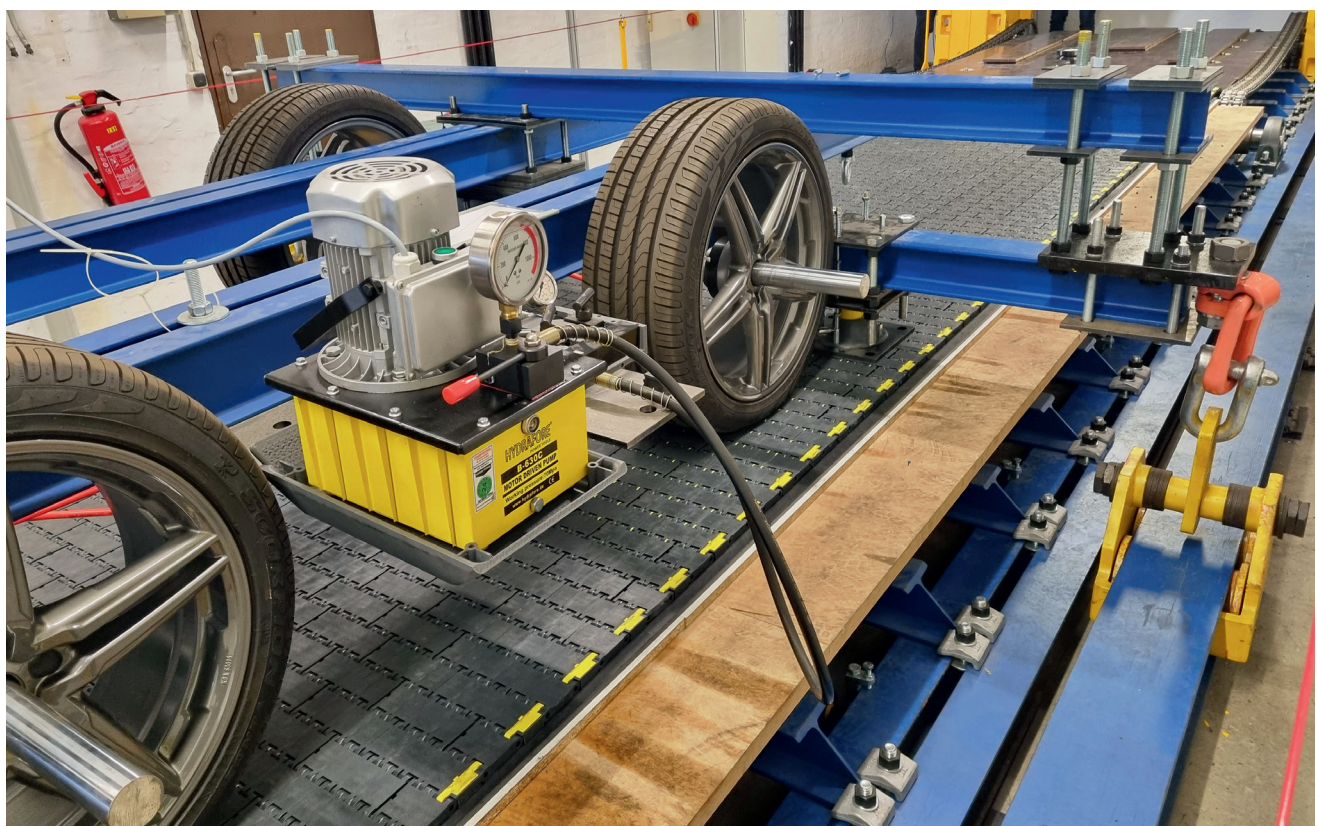
下图 一组车轮可模拟汽车。液压缸可 根据需要改变塑料模块带负载。
