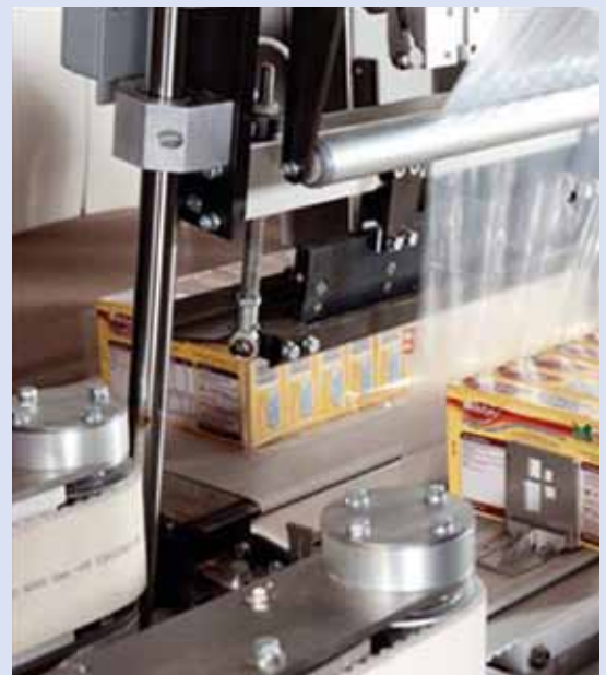
Siegling Proposition Zahnriemen in einer Verpackungsmaschine.
