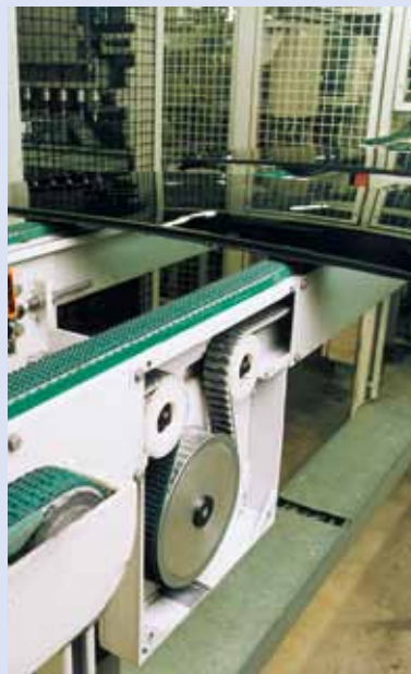
Transport von Pkw-Scheiben mittels Synchronantrieb. Die Beschichtung der Zahnriemenrücken schützt das Fördergut und verbessert die Mitnahmeeigenschaften.
