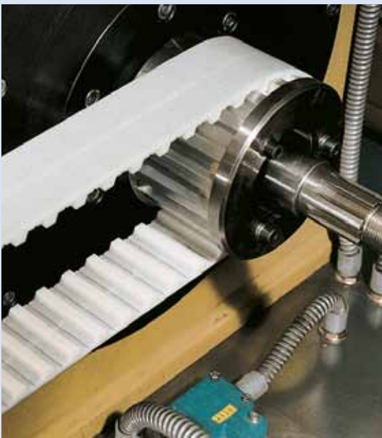
Siegling Proposition Zahnriemen auf einem Leistungsprüfstand.
