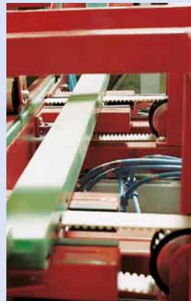
Transport von Pkw-Scheiben mittels Synchronantrieb. Die Beschichtung der Zahnriemenrücken schützt das Fördergut und verbessert die Mitnahmeeigenschaften.
