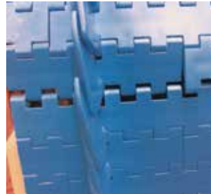
1 Schieben Sie die Bandenden korrekt zusammen.
