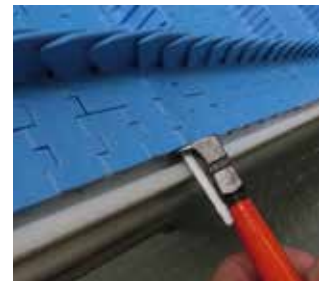
4 Kürzen Sie das Stabende, welches über die Bandkante hinausragt.
