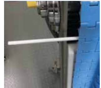
2 Setzen Sie den Stab ein.
