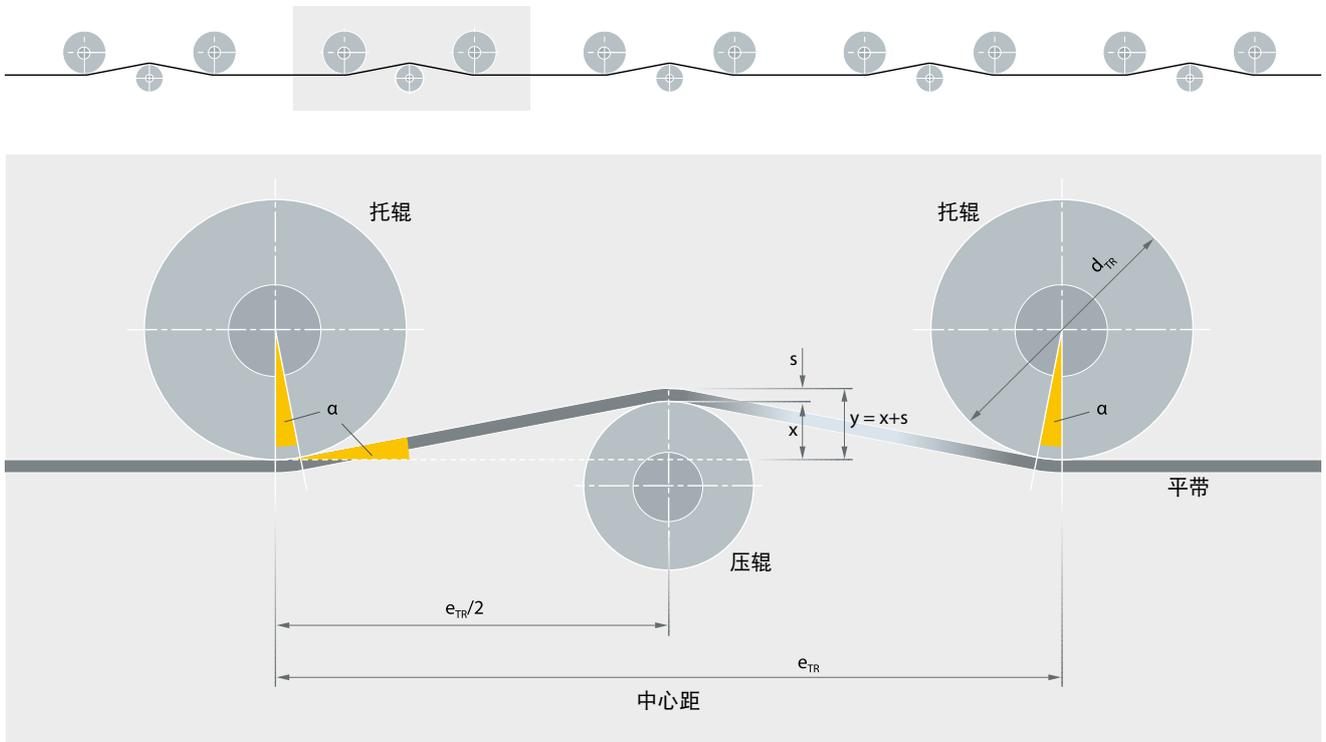
注意：辊轴输送机计算的良好初始值是接合深度 $y$ 等于带子厚度 $s$ 的一半。
