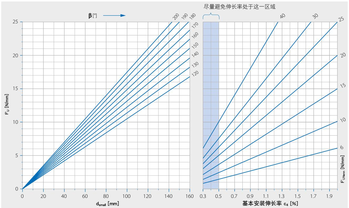
关于聚酯系列的说明：对于具有 U 涂层的带体，由于聚氨酯的结构强度较小，因此要将可传递的有效拉力降低 1/3。视类型而定，基本安装伸长率可以  $> 2.0\%$ ，但是应咨询福尔波传送系统应用技术部门。
