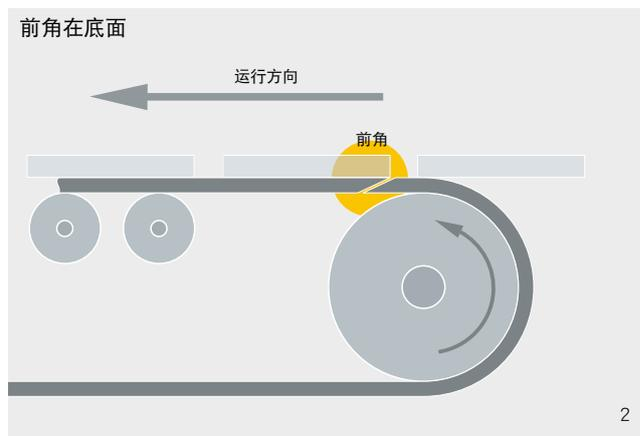
反过来，如果将平带来输送研磨性物品，例如纸张，则应该看重的是输送物品在平带上的输送性能，所以前角应该位于带与输送物品接触的另一侧。在这种情况下，带与带轮的接触是次要的。因此推荐插图 2 中所示的方位。
