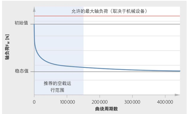
提示：轴负荷稳态值可作为计算平带功率传递的基础。但是设计师至少应在根据静载荷计算轴承尺寸时考虑较高的轴负荷初始值。
