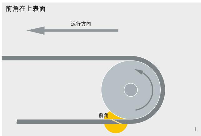
例如，如果在双辊轮传动机构中使用平带作为传动带，由于带轮通常是与平带的唯一接触，因此应该看重的是平带在带轮上的包覆性，所以前角应该位于带与带轮接触的另一侧。为了保证楔形接驳有更好的稳定性，插图 1 中所示的方位是合理的。
