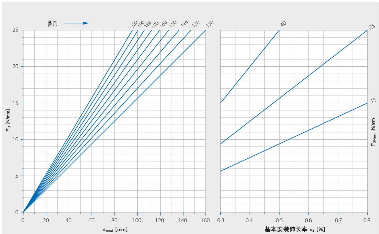
关于芳纶系列的说明：对于具有 U 涂层的带体，由于聚氨酯的结构强度较小，因此要将可传递的有效拉力降低 1/3。视类型而定，初始安装伸长率可以 >0.8%，我们建议咨询福尔波传送系统应用技术部门。
