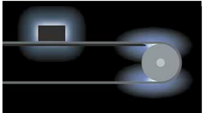
静电通过被输送物品及摩擦起电。
