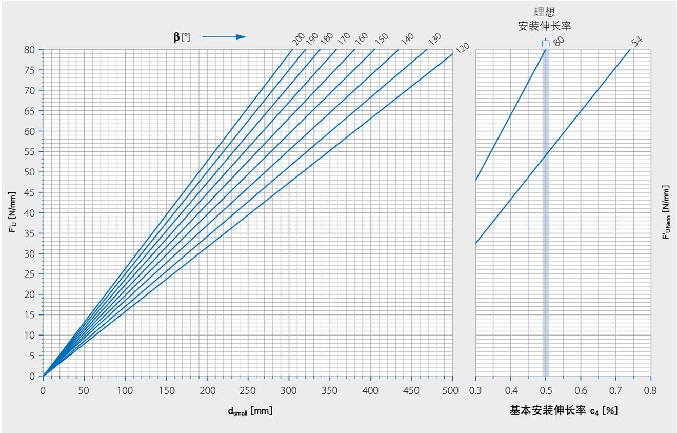
关于芳纶系列无接口环带的说明：带体承载能力高，如果使用U涂层的带型，则也允许低于图中所示的直径极限。在某些运行条件下，可传递的有效拉力同样可能升高到远远超过名义有效拉力的程度。如果是高负荷的传动系统，我们建议与福尔波传送系统应用技术部门联系。
