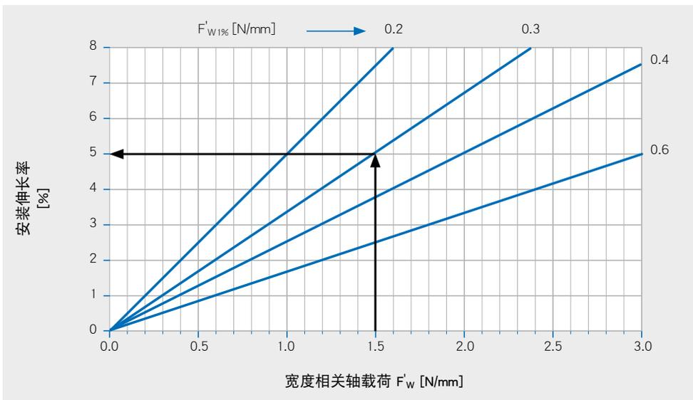
图2：确定安装伸长率
