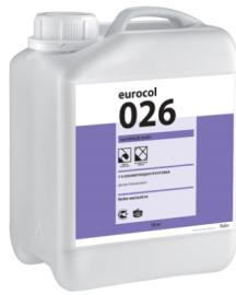
Блокирующая грунтовка. Применяется для изоляции остаточной влаги в цементных стяжках до 4 СМ% по карбидному методу, а так же в качестве адгезионной грунтовки к различным продолжительно сухим основаниям (цементная/ангибитная стяжки, древесные плиты), в том числе в процессе санации полов (терраццо, керамическая плитка, литой асфальт) перед использованием kleев, выравнивающих и ремонтных масс Eurocol, внутри помещений. Однокомпонентная, не содержит растворителей, экономичный расход, быстросохнущая.
