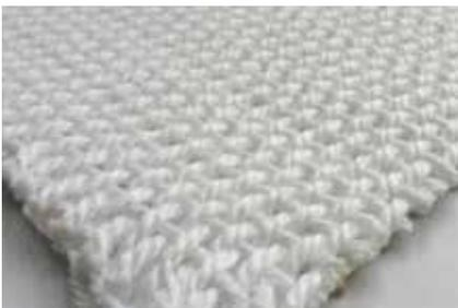
Mehrlagengewebe, das in Transtex-Typen eingesetzt wird („interwoven fabric“)
