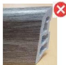
2. Pour la réalisation de l'embout à coller à l'extrémité de la plinthe qui a été précédemment découpée, il faut soit prendre l'embout droit d'une plinthe soit réaliser une découpe droite dans une chute. Lorsque celle-ci est réalisée, découper à 45° l'autre extrémité de l'embout à 15mm de la partie droite lorsque l'on regarde le dessin de la plinthe.
