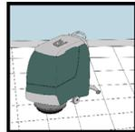
6. Rincez toute la surface avec une vadrouille propre et de l'eau fraîche propre. Ramassez l'eau de rinçage à l'aide d'un aspirateur sec et humide ou d'une récurveuse automatique.
