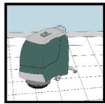
5. Ramassez la solution nettoyante à l'aide d'un aspirateur sec et humide ou d'une récreuse automatique.
