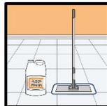
8. À l'aide d'un tampon applicateur d'enduit de protection Scotchgard 59646 pour planchers, appliquez une couche moyennement chargée et uniforme sur le plancher, sans laisser de flaques. Humidifiez toujours le tampon applicateur avec de l'eau et essorez-le légèrement avant de l'utiliser.
