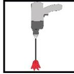
3. Placez la palette hélicoïdale au fond du seau de 2 gallons à fond plat. Assurez-vous que la palette hélicoïdale est toujours en contact avec le fond du seau lorsque vous mélangez.
