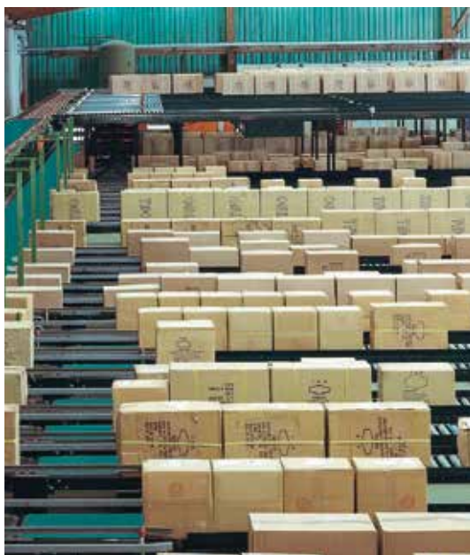
伸缩输送机(上图)适合于反向弯曲，可适用于高载荷。 堆积输送机(下图)需要很光滑和坚固的表面。
