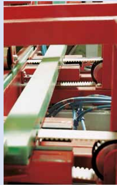
벨트를 동시에 움직여 자동차 창문을 운반함. 타이밍 벨트 후면 커버링이 제품을 부드럽게 다루되 향상된 그림을 제공.
