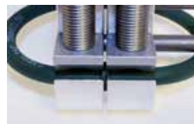
Verbindung abkühlen lassen
