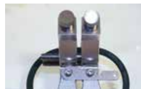
RPZ auf den korrekten Riemen-durchmesser einstellen
