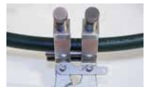
Riemenenden in die Zange einlegen und fixieren
