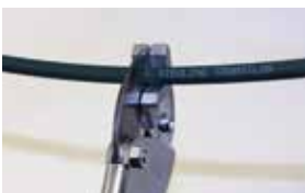
Rundriemen auf die richtige Länge schneiden
