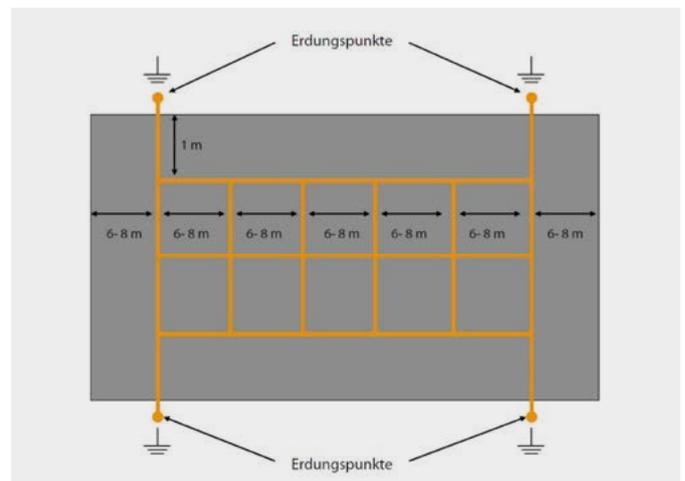
Leitfähig eingestellte Klebstoffe sorgen für die Leitfähigkeit vom Belag zum Untergrund. Für die Verklebung von Colorex SD/EC sind leitfähige, weichmacherbeständige und lösungsmittelfreie Dispersionsklebstoffe, die für Vinylbeläge geeignet sind (z.B. Eurocol 641), zu verwenden. Bei der Auswahl der Zahnung beachten Sie bitte die Empfehlungen des Klebstoffherstellers. Um immer eine ausreichende Auftragsmenge des Klebstoffs zu gewährleisten, ist ein frühzeitiges Wechseln der Zahnleiste notwendig.
