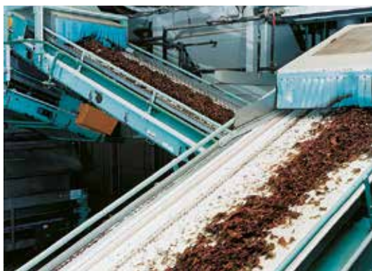
Transport w przemyśle tytoniowym. Do kąta przenoszenia wynoszącego 22° można również zastosować typy taśm o gładkich powierzchniach.
