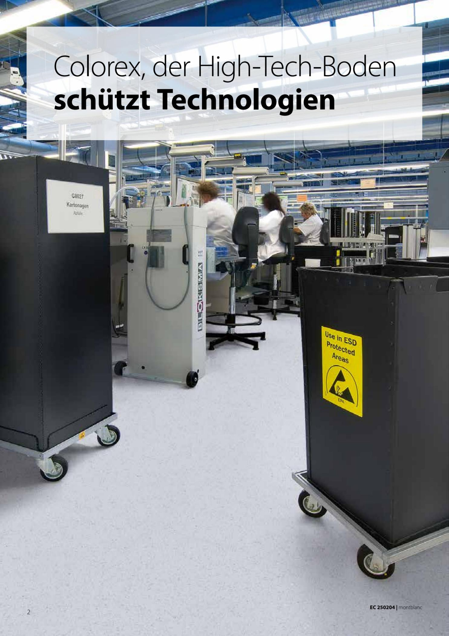
Colorex ist ein High-Tech-Vinylboden für die Anwendung im Reinraum, in ESD- und Klinikbereichen sowie in der Industrie. Dieser hochdruckverpresste Vinylbelag erfüllt aufgrund seiner Materialzusammensetzung und angewandten Produktionstechnik höchste Qualitätsanforderungen und garantiert u. a. lebenslange Leitfähigkeit.
