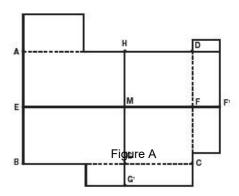
Tracez la ligne médiane comme suit : dessinez une ligne à la craie du centre du mur A-B (= E) au centre du mur C-D (= F). Identifiez le point médian de la ligne E-F (= M). Tracez une ligne perpendiculaire passant par M en utilisant la méthode 3:4:5 pour obtenir la ligne G-H (figure A).
