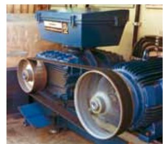
Les courroies de transmission Siegling Extremultus sont d'une efficacité ( $\geq 98\%$ ), d'une précision de synchronisation et d'une facilité d'utilisation exceptionnelles.
