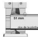
Placer ensuite la plinthe en ajustant le repère précisément sur l'arête de la surface de butée. Abaisser le levier pour gruger l'angle extérieur.
