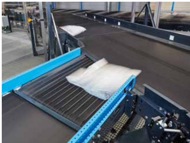
Dans le cas des **injecteurs**, les bandes fonctionnant en jeu ont une tension commune. Cela exige des tolérances de longueur particulièrement serrées. Les coefficients de frottement élevés sur la face transport garantissent le transfert précis au trieur.
