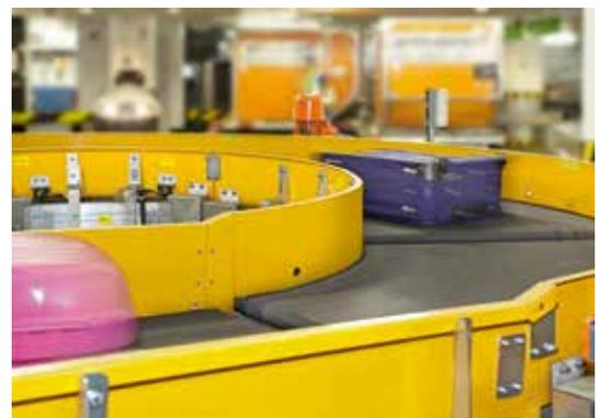
La fabrication des **bandes courbes** en plusieurs segments permet de répartir les forces le mieux possible de façon à garantir également le transport de produits lourds.
