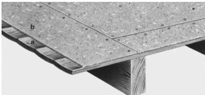
Utilisez des vis à tête noyée que vous alignerez face à face tous les 25 centimètres environ en prévoyant des vis supplémentaires au niveau des joints. Veillez bien à ne pas fermer totalement les joints entre les panneaux d'aggloméré. Ensuite, poncez soigneusement les joints. Les joints des panneaux d'aggloméré ont tendance à transparaître, si le matériau se met à travailler (gonfler). Ce phénomène est lié à la structure et à la qualité du matériau, mais aussi aux variations d'humidité relative.
