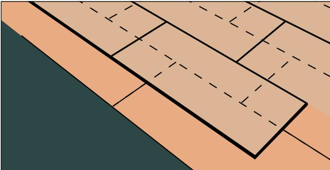
*Les panneaux supérieurs du système de sous-revêtement en MDF sont disposés en demi-brique sur les panneaux inférieurs.*
