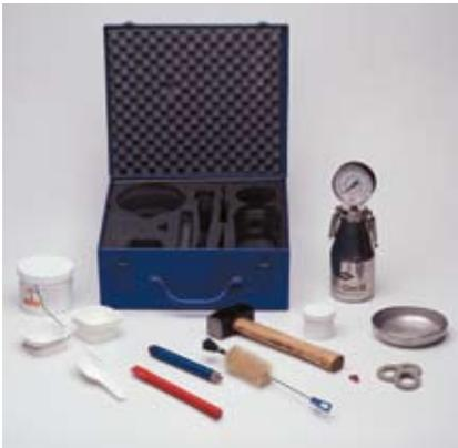
Procédez à plusieurs mesures pour avoir une bonne vue d'ensemble. Vérifiez également si le support a la même épaisseur partout. Plus la chape est épaisse, plus il faut de temps pour qu'elle soit complètement sèche. Un hygromètre électrique permet de déterminer les zones les plus humides, la mesure précise pouvant être effectuée à l'aide de l'hygromètre CM.
