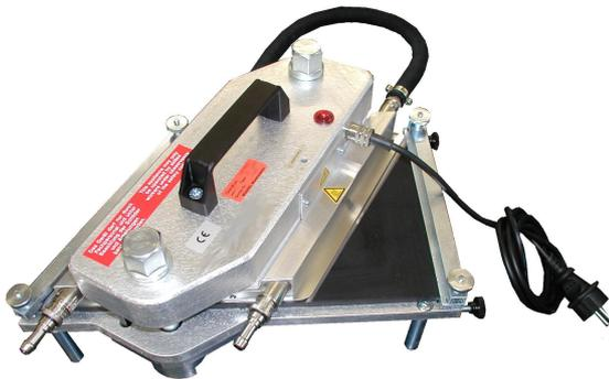
Heizpressen sind Elektro-Temperiergeräte, bestimmt für den Einsatz beim Konfektionieren (Verbinden) von Forbo Siegling Bandmaterial, welches für die maximal auftretenden Temperaturen von 110°C geeignet ist.
