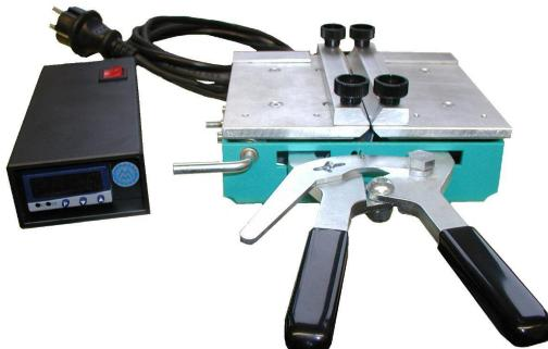
Heizgeräte des Typs SMX-BD-0/100-3V sind Elektro-Temperiergeräte, bestimmt für den Einsatz beim Konfektionieren (Verbinden) von Forbo Siegling Bandmaterial, welches für die maximal auftretenden Temperaturen von 210°C geeignet ist.
