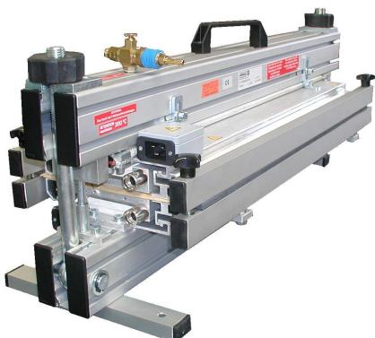
Heizpressen sind Elektro-Temperiergeräte, bestimmt für den Einsatz beim Konfektionieren (Verbinden) von Forbo Siegling Bandmaterial, welches für die maximal auftretenden Temperaturen von 200°C und einen Presseneingangsdruck von 5 bar geeignet ist.
