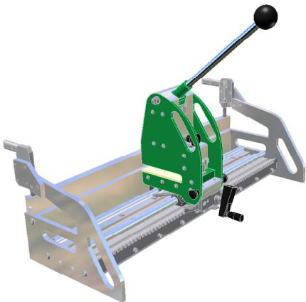
Stanzgeräte des Typs PP-ZPB-V/300 – 1500 dienen zur Vorbereitung von Z- und Z-Stufenverbindungen für Transportbänder in den Bandbreiten 300 bis 1500 mm. Das Gerät setzt sich aus einem in verschiedenen Breiten erhältlichen Grundrahmen sowie einem abnehmbaren Stanzkopf zusammen, die je nach Kundenanforderung separat bestellt werden.
