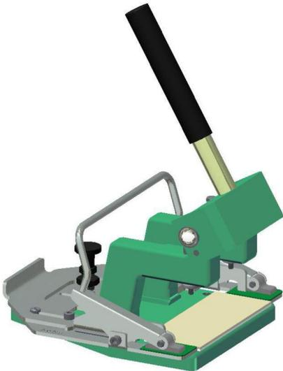
Stanzgeräte des Typs PP-ZP-V/40-3 dienen zur Vorbereitung von Z-Verbindungen für Riemen und Bänder mit einer Bandbreite bis 40 mm. Dabei können Verbindungslängen von 35, 70 und 110 mm symmetrisch gestanzt werden. Der Verschiebetisch mit Einstellmöglichkeit der symmetrischen Stanzung ist im Lieferumfang enthalten. Ohne Stanzmesserset!
