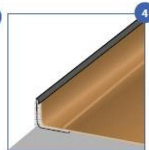
4 Coller une première bande de revêtement à l'intérieur de la plinthe complète de façon à pouvoir souder à chaud cette bande et le lé au niveau du plat de la plinthe.
