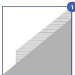
1 Appliquer une bande sèche ou de la colle sur une hauteur de 10 cm sur le mur.
