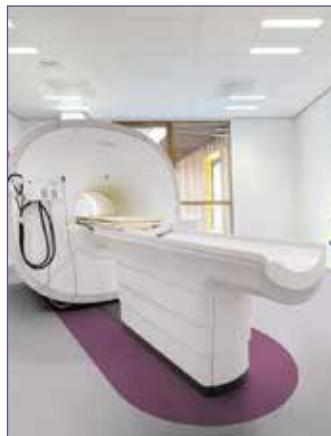
Fourniture et pose d'un revêtement de sol PVC homogène en lés de 2 m de large conforme au classement européen 34/43, approuvé pour la construction de salles propres ISO classe 4 selon norme EN14644-1 de type SPHERA SD ou EC.
