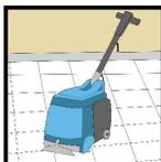
3. Utilisez un extracteur autonome, de préférence avec des brosses contrarotatives, pour enlever les taches du revêtement de sol en utilisant uniquement de l'eau propre. Réglez les brosses pour assurer une agitation maximale et entrer en contact avec les fibres.
