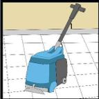
6. Utilisez un extracteur portable autonome, de préférence avec des brosses contrarotatives, pour enlever les taches du revêtement de sol en utilisant uniquement de l'eau propre. Réglez les brosses pour assurer une agitation maximale et entrer en contact avec les fibres.
