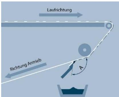
Der Abstreifer sollte das Band leicht im Untertrum berühren, direkt nachdem das Produkt abgesetzt wurde. Der Winkel "A" beträgt normalerweise zwischen 100 und 120 Grad.
