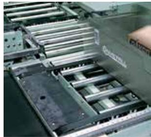
ジークリング エクストレマルタス ドラッグベルトは機械的特性と帯電防止特性を備えるために特別に開発された製品です。電子部品等の高効率かつ安全な搬送およびハンドリングを実現します。
