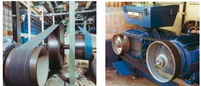
ジークリング エクストレマルタス 動力伝動ベルトは98%以上という高い効率を誇り、他の駆動エレメントと比較して高い同期性と簡単な取り扱いというメリットを備えています。
