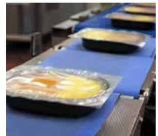
ジークリング エクストレマルタス マシンテープ は多くの工業用途に欠かせないマシンエレメントです。ポリエステル帆布、ポリアミドベルト、ポリウレタンの心体を使用し、幅広い用途分野での使用を可能としています。ジークリング エクストレマルタス マシンテープの特長は以下の通りです。
