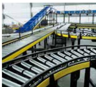
ジークリング エクストレマルタス ライブローラベルトは、流通プロセスにおける高速性と安定性を実現する長寿命な省エネ動力伝動ベルトです。
