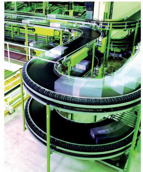
Bild 3: Kurvenbandanlagen wie diese müssen über eine äußerst flexible Gewebekonstruktion verfügen
