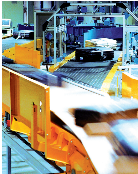
Bild 2: Über parallel laufende Einzelbänder werden die Gepäckstücke auf einen Kippchalensorter übergeben
