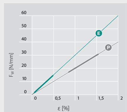
Durch die geringe Auflegedehnung (hervorgehobener Bereich) ergibt sich bei den Polyester Typen eine verringerte Wellenbelastung im Vergleich zu herkömmlichen Produkten mit Polyamid-Zugtrger.
