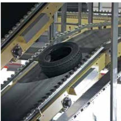
Forbo Siegling hat eine Vielzahl von **Oberflächenstrukturen** für sehr unterschiedliche Anwendungen entwickelt und optimiert. Mit Siegling Transilon Strukturbändern können Anstiegswinkel bis zu 30° ohne Profile realisiert werden.
