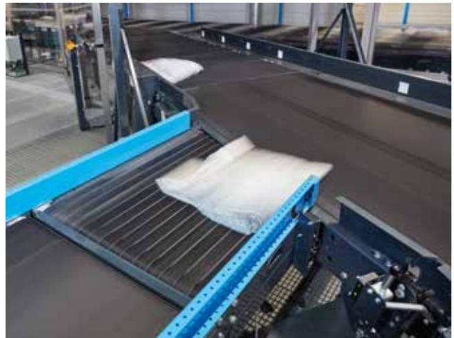
Bei **Einschleusungen** werden die im Satz laufenden Bänder normalerweise gemeinsam gespannt. Das erfordert besonders niedrige Längstoleranzen. Hohe Reibwerte auf der Tragseite garantieren die präzise Übergabe an den Sorter.
