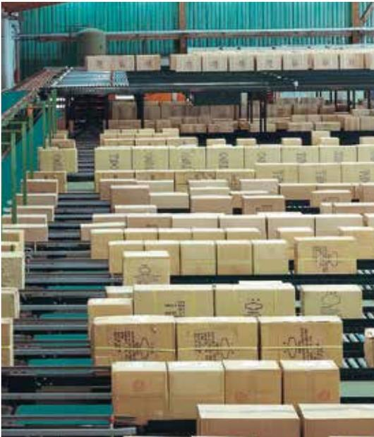
**Teleskopbänder** (oben) sind für den Lauf mit Gegenbiegung ausgelegt und bewältigen gleichzeitig hohe Punktlasten.
