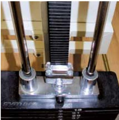
Beim Krafttraining gewährleisten Siegling Powerbelts Zuverlässigkeit, Sicherheit und eine lange Lebensdauer. Massen von 100 kg und mehr werden problemlos auch über kleine Kunststoffrollen umgelenkt.
