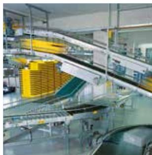
Sichere Schrägförderung durch strukturierte oder mit Querprofilen versehene Transportbänder.
