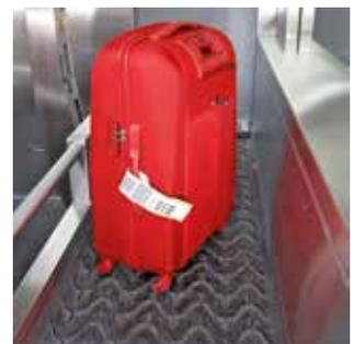
Gute Mitnahme durch spezielle Oberflächenstrukturen. Auch die problematischen Rollenkoffer werden sicher gefördert.
