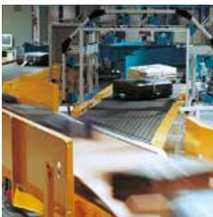
Zuverlässige Fördergutübergabe durch kleine Umlenkradien; kurze Spannwege durch enge Längentoleranzen der Bänder.
