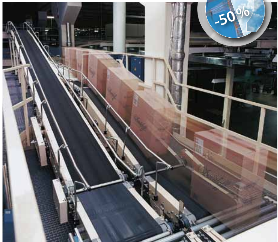
Starke Beschleunigungen im Stop-and-Go-Betrieb bei hohen Punktlasten stellen hohe Anforderungen an die eingesetzten Bänder.
