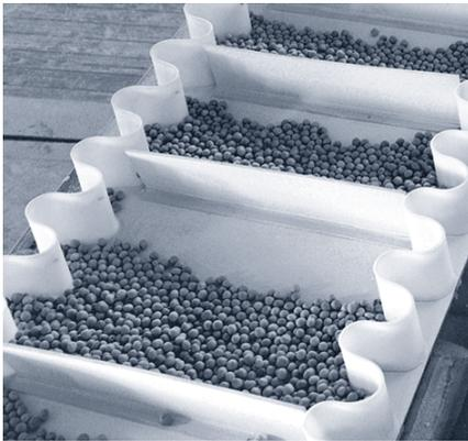
Les bandes transporteuses munies de profils sont utilisées pour le transport sur plan incliné de produits en vrac et de pièces détachées.
