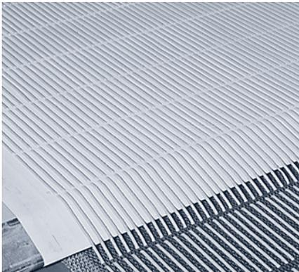
Les bandes Siegling Transilon sur sabres/couteaux, grâce à leur construction de tissu, sont particulièrement flexibles dans le sens longitudinal et rigides dans le sens transversal. Elles sont adaptées aux sabres/couteaux d'un rayon à partir de 3 mm.
