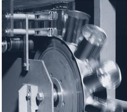
Les bandes Siegling Transilon NA (non antistatiques) sont électriquement non conductibles. Contrôlées selon ISO 21178, les résistances électriques sont en principe supérieures à  $3 \times 10^8 \Omega$ .
