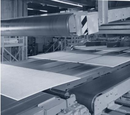
Les bandes Siegling Transilon en version antistatique sont pourvues de fils conducteurs tressés dans l'âme polyester, pas de contact direct pour éviter leur usure.
