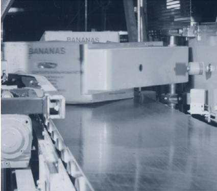
Les bandes d'accumulation sont utilisées pour stocker les produits transportés derrière une barrière de stockage ou pour le chargement ou le déchargement. L'exécution particulièrement rigide transversalement des bandes, même en grandes largeurs, assure une bonne planéité. Le chargement ou le déchargement latéral du produit transporté se fait donc sans aléas.
