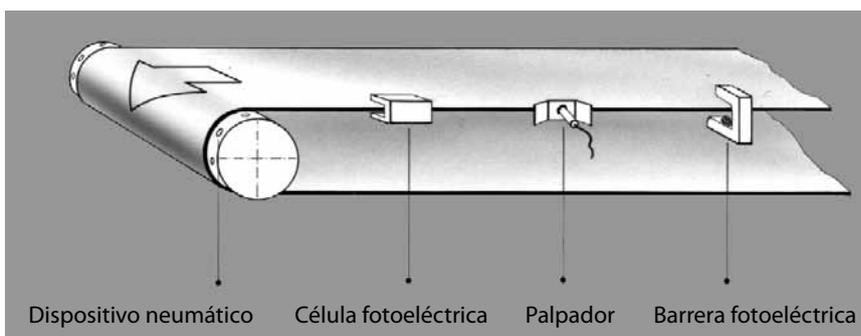
Los controles de banda automáticos suelen estar dotados de rodillos de presión pivotantes. En la mayoría de los casos, el ajuste se efectúa con la ayuda de husillos roscados accionados eléctricamente o mediante cilindros neumáticos, según los valores reales del canto de la banda, determinados por el sensor de cantos de banda.
