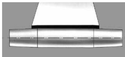
La banda es demasiado estrecha. Solución: ajustar el paso al ancho de la banda.
