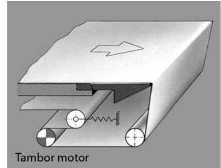
dependiente de la fuerza, colocado a continuación del tambor motriz, en vez de la habitual estación de tensado de husillos. Este tambor tensor móvil reduce la tensión de la banda en el canto de cuchilla y puede disminuir notablemente la fuerza de fricción de este canto en comparación con un sistema de tensado de husillos fijo.
