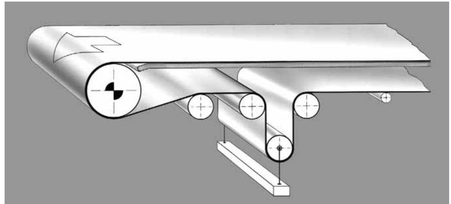
En caso de influencia térmica elevada y cambiante, se recomienda instalar un dispositivo de tensado dependiente de la fuerza.
