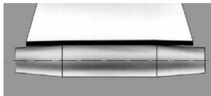
Conicidad demasiado acusada. La banda no está en contacto y no es guiada. Si la distancia entre ejes es corta, la elongación de montaje debe elegirse de manera que los cantos de la banda tengan contacto en todo momento.
