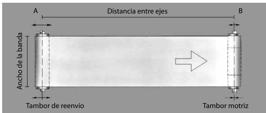
Los tambores cónico-cilíndricos deben disponerse de manera que puedan ajustarse para compensar las tolerancias de fabricación de la instalación y de la banda.
