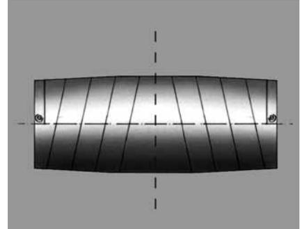
Para evitar efectos no deseados en el guiado se recomienda, sobre todo en tambores anchos, enrollar el forro de fricción de manera simétrica desde los extremos hacia el centro del tambor, con menos radio hacia los extremos. Los forros de tambor estructurados (p. ej., modelos romboidales) también deben estar simétricamente alineados con respecto al centro del tambor.
