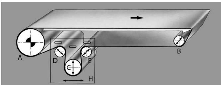
Las bandas en filo de cuchillo más cortas pueden guiarse como se representa en la figura. El tambor motriz A debe ser cónico-cilíndrico, mientras que los tambores de reenvío B, D, E y el tambor tensor C deben ser cilíndricos y ajustables para regular la banda en el sentido que indica la flecha.
