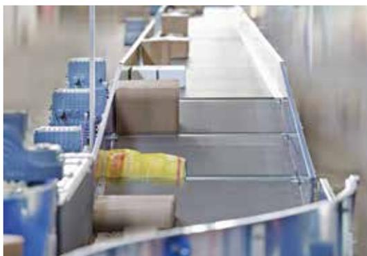
I nuovi nastri elastici Forbo Siegling permettono di risolvere definitivamente i problemi di stabilità in guida. Grazie al nucleo di trazione monotela con fili di ordito elastico, i nastri avanzano in modo particolarmente stabile. Riescono inoltre a compensare minimi errori di allineamento dell'impianto.
