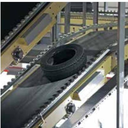
Forbo Siegling ha sviluppato e ottimizzato molteplici **strutture superficiali** per le più diverse applicazioni. I nastri strutturati Siegling Transilon consentono di ottenere angoli di salita fino a 30° senza profili.
