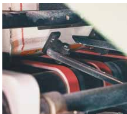
Beschleunigungsband für den Abzug von gestapeltem Material zur Herstellung gefalteter Getränketüten.
