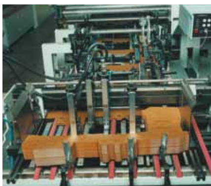
Vakuumgestützter Abzug von Kartonagen mit Hilfe gelochter Siegling Linpack Riemen.
