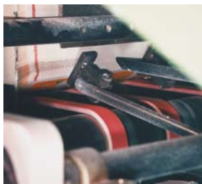
Courroie d'accélération pour l'extraction de produits empilés pour la fabrication de boîtes pliées pour boisson.
