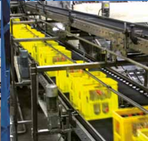
Auch bei sehr hoher Beladung und nassem Fördergut können große Steigungswinkel realisiert werden.
