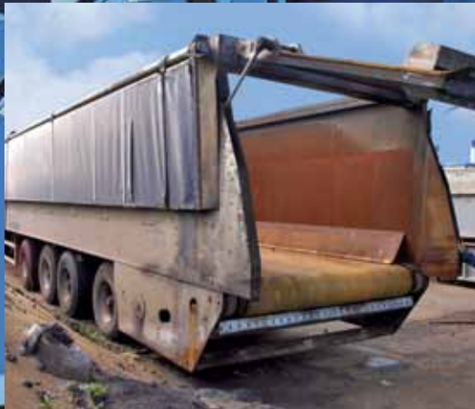
Entladeband für 40 Tonnen Steinkohle. Erst Siegling Transtex macht diese kompakte Anlagenkonstruktion möglich.
