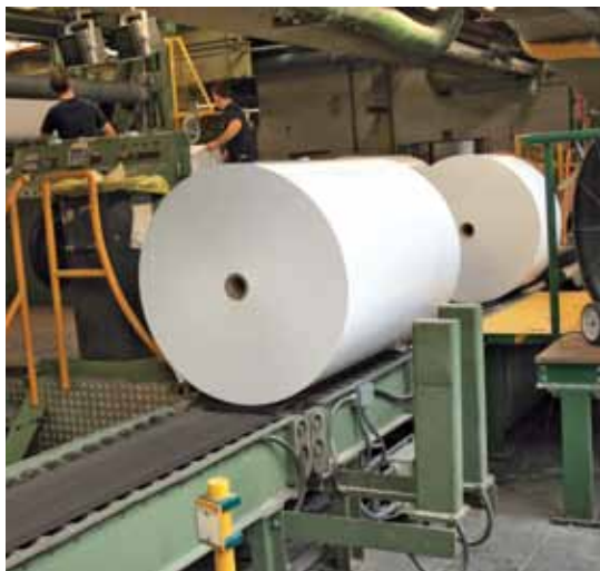
Punktlasten von 1500 kg werden mit Siegling Transtex souverän bewegt, ohne die äußeren Papierlagen zu beschädigen.
