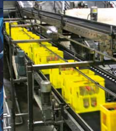
Auch bei sehr hoher Beladung und nassem Fördergut können große Steigungswinkel realisiert werden.
