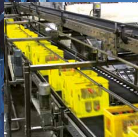
De grands angles de rampe peuvent être réalisés même en cas de lourd chargement et de marchandise transportée mouillée.
