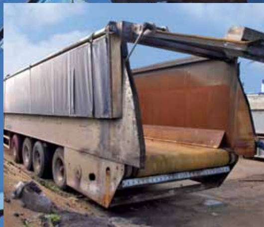
Bande de déchargement pour 40 tonnes de houille. Cette construction compacte d'installation est devenue possible grâce à Siegling Transtex.
