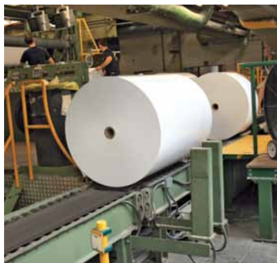
Siegling Transtex déplace aisément des charges ponctuelles de 1500 kg, sans endommager les couches de papier extérieures.
