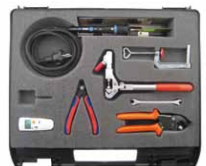
Combi-Set TC, comprenant pince de pressage courroie ronde avec leviers de tension rapide
