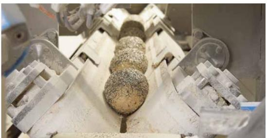
Durch unterschiedliche Bandgeschwindigkeiten werden in der Großbäckerei Rundlinge geformt.
