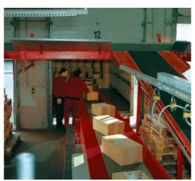
Teleskopbänder – hier bei der LKW- Beladung eingesetzt – müssen für den Lauf mit Gegenbiegung ausgelegt sein und gleichzeitig hohe Punktlasten bewältigen.
