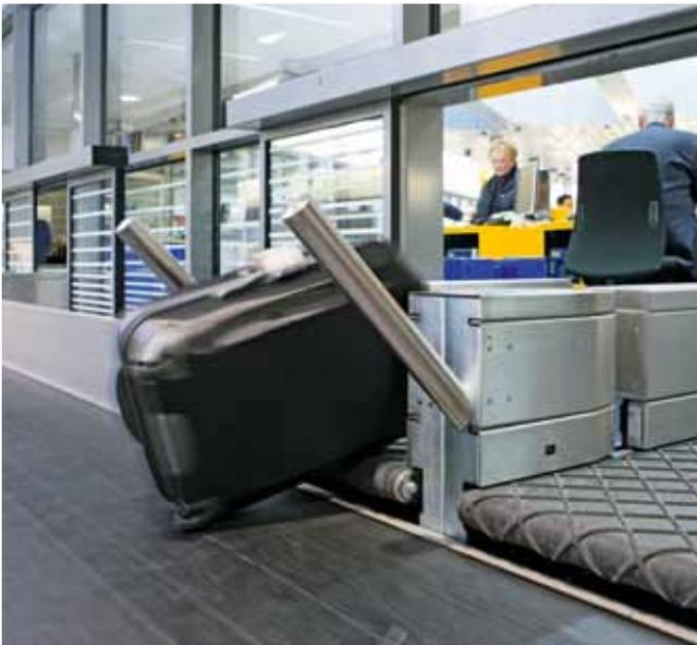
Sammelband im Check-In-Bereich eines Flughafens. Die gute Planlage des eingesetzten Bandtyps gewährleistet auch bei größeren Bandbreiten problemloses seitliches Aufschieben des Transportgutes. Die schwer entflammbare Ausführung ist ein „Muss“ in modernen Flughäfen.
