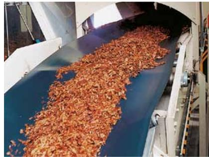
Horizontaltransport mit muldungsfähigem Band. Die Zugträger-Konstruktion bewirkt die Biegeweichheit in der gewünschten Richtung.
