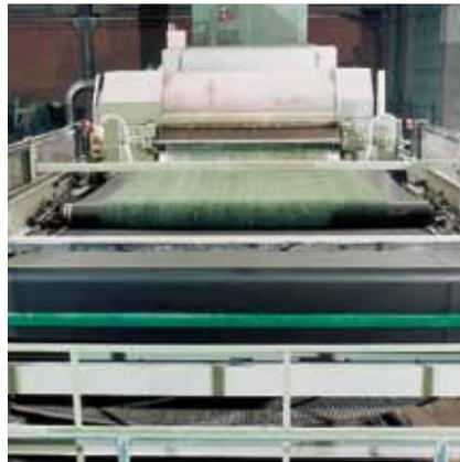
Kreuzlegen von Vlieslagen in der Nonwoven-Industrie. Hohe Produktionsgeschwindigkeit und Massenbeschleunigung – bei direkter Vliesführung zwischen den Bändern – stellen höchste Ansprüche an die eingesetzten Prozessbänder.
