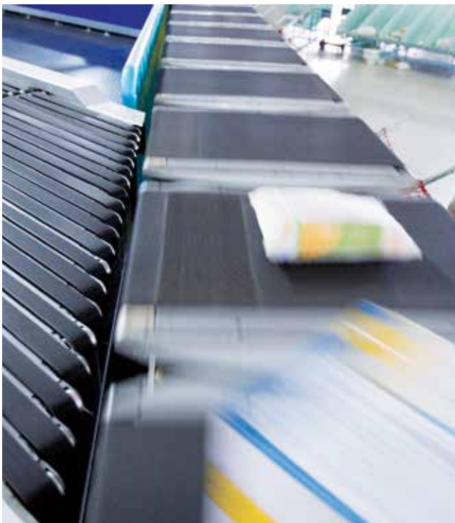
Equipo de selección transversal en un centro de distribución. La alta aceleración exige valores de rozamiento extremadamente favorables de la superficie de banda.
