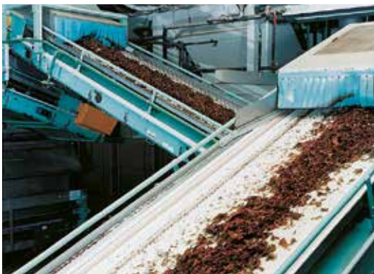
Transporte inclinado en la industria tabaquera. En esta zona se pueden emplear tipos de banda de superficie lisa con ángulos de hasta 22°.
