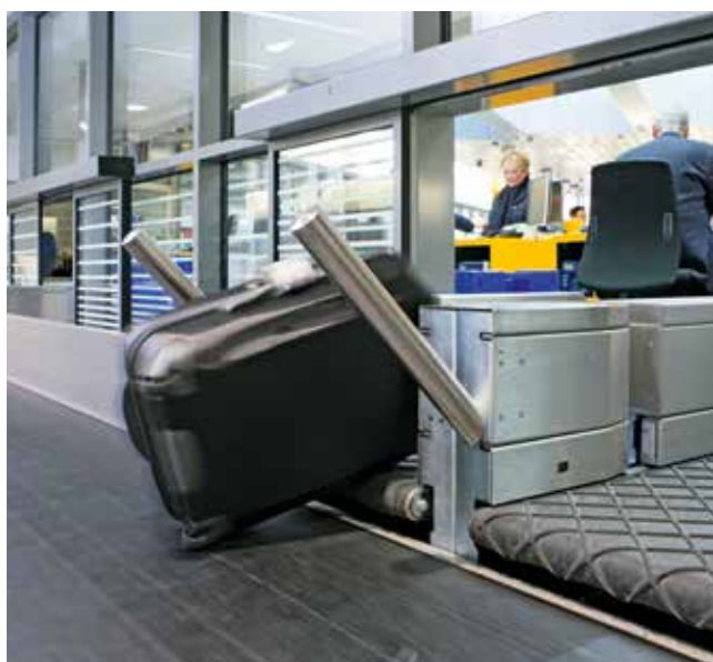
Banda colectora en la zona de facturación de un aeropuerto. Incluso para grandes anchos de banda la perfecta planitud del tipo utilizado garantiza la alimentación lateral sin problemas. En los aeropuertos modernos son obligatorias las bandas de material difícilmente inflamable.
