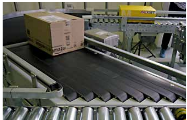
Equipo de selección transversal en un centro de distribución. La alta aceleración exige valores de rozamiento extremadamente favorables de la superficie de banda.
