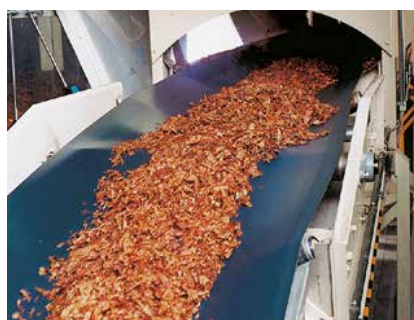
Transporte horizontal con una banda en artesa. La construcción del elemento tractor produce la flexibilidad en el sentido deseado.
