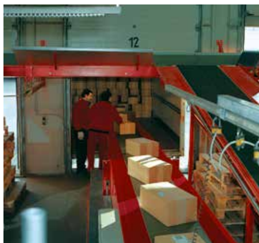
Bandas telescópicas – en la carga de un camión – deben ser concebidas para contraflexión, a la vez que han de superar altas cargas puntuales.
