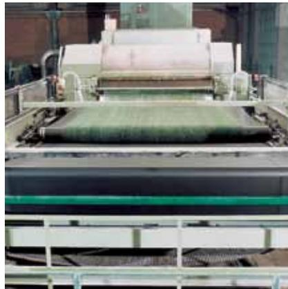
Superposición de capas de velo en la industria del Nonwoven. La alta velocidad de producción y la aceleración de masas con conducción directa del velo entre las bandas exigen un máximo a las bandas de procesamiento empleadas.
