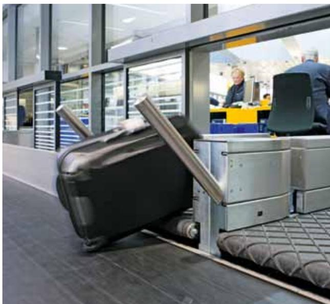
Banda colectora en la zona de facturación de un aeropuerto. Incluso para grandes anchos de banda la perfecta planitud del tipo utilizado garantiza la alimentación lateral sin problemas. En los aeropuertos modernos son obligatorias las bandas de material difícilmente inflamable.
